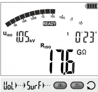
Después de completar la medición se pueden leer los resultados. Con los botones **F3** y **F4 (PANTALLA)** se puede ver los distintos componentes en el orden:
