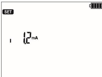
La corriente máxima  $I_{sc}$  forzada por el medidor:
