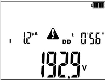
Pantalla durante la medición. Fase dos: despolarización del objeto. El medidor indica:
