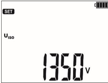
Tensión de medición  $U_n$  (solo para las posiciones **50...15000 V**).
