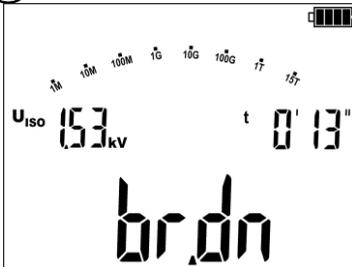
Si durante la subida de la tensión se produce la rotura del aislamiento, el medidor mostrará:
