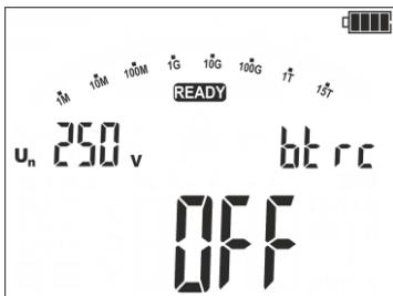
Si el control remoto está inactivo, el intento de activar la medición desde la aplicación móvil hace que aparece el mensaje **bt rc OFF**.
