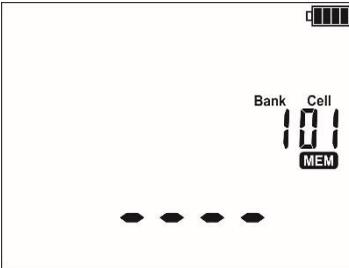
Después del borrado del banco, el medidor emite una triple señal sonora y establece el número de celda en "1".
