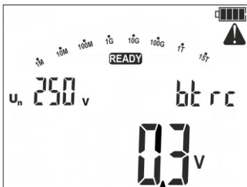
El control remoto está activo - se muestra el mensaje **bt rc**. En la esquina de la pantalla parpadea un triángulo de advertencia.
