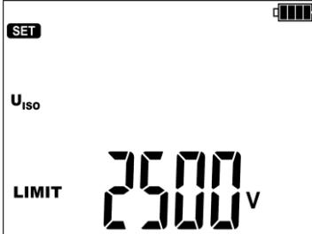
La tensión de medición final **U<sub>iso</sub> LIMIT**. Está en el rango de 50 V...15 kV.
