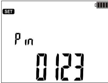
**PIN** para la conexión vía Bluetooth. El dígito ajustado parpadea. Ir al siguiente dígito con los botones **F3** y **F4**.
