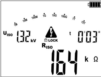
Si se produce la ruptura del aislamiento, el medidor no interrumpe la medición. La medición dura hasta que se acabe el tiempo ajustado en el paso (3).
