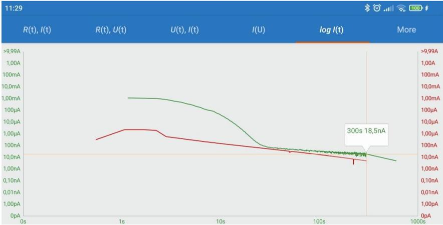
Si la forma de las curvas es similar, esto significa que el objeto examinado está en buenas condiciones. Jeśli krzywe odstają od siebie, może to oznaczać degradację izolacji. Su grado se puede determinar según la diferencia entre las curvas y su característica: en qué punto de la medición se produjo esta diferencia.
