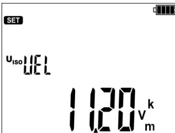
Velocidad de subida de la tensión **U<sub>iso</sub> VEL**. Está en el rango de 100 V/min...12 kV/min. Por ejemplo:
