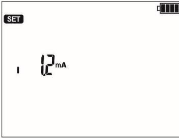
La corriente máxima de cortocircuito  $I_{sc}$  forzada por el medidor:
