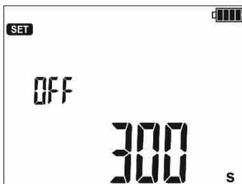
Tiempo **hasta el apagado automático** (300 s, 600 s, 900 s) o falta de tiempo (- - - -).
