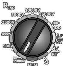
Poner el selector giratorio de función en una de las posiciones **R<sub>ISO</sub>**, seleccionado al mismo tiempo la tensión del medición.
