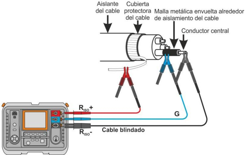
Del mismo modo es el proceso cuando se mide la resistencia de aislamiento entre dos conductores del cable, al terminal **G** conectamos otros conductores que no participan en la medición.
