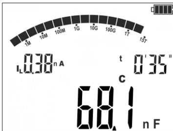
El equipo mide la capacidad total del cable C. Sabiendo la capacidad unitaria  $C_x$ , se puede calcular la longitud L.
