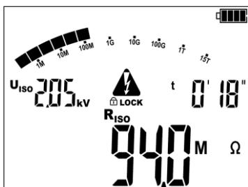
Pantalla durante la medición. Primera fase: polarización del objeto. El medidor indica:
