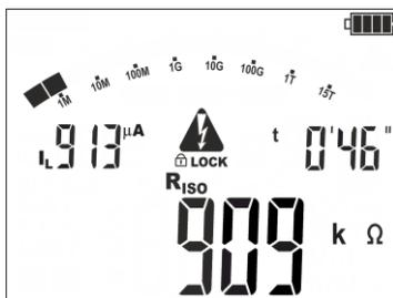
Pantalla durante la medición. Primera fase: polarización del objeto. El medidor indica:
