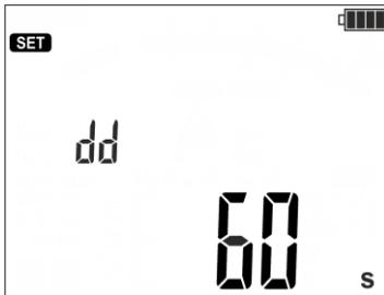
**Tiempo de medición de la corriente de fuga** para la función **DD**.
