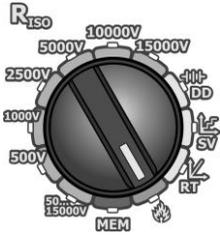
Poner el conmutador rotativo de la selección de funciones en la posición **Método de quemado**. El medidor está en el modo de medición de tensión.
