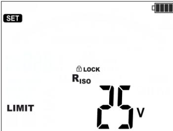
El valor mínimo de la tensión de interferencia de CA en el objeto examinado que es señalado por el medidor con el mensaje **NOISE**. Ajustes disponibles: 25 V, 30 V, 35 V... 1495 V, 1500 V.
