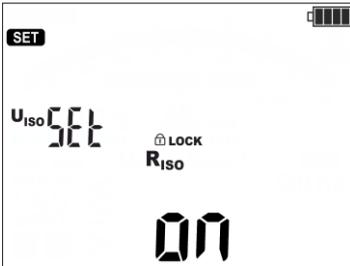
**Prueba de tensión** activación (ON) y desactivación (OFF).
