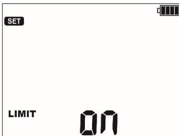
Ajustes de **límites**: activación (**0n**) y desactivación (**0ff**).
