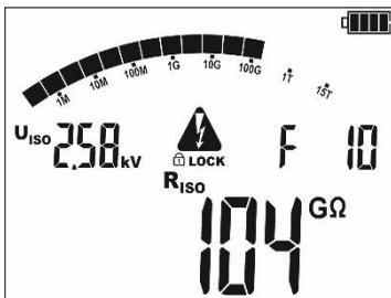
El dispositivo tiene un **filtro digital** avanzado que permite la estabilización del resultado en las condiciones de medición difíciles e inestables. Pulsando el botón **F1** antes o durante la medición el dispositivo hace cálculos para estabilizar el resultado de la medición. El medidor muestra el valor filtrado de las mediciones en el intervalo de tiempo seleccionado.
