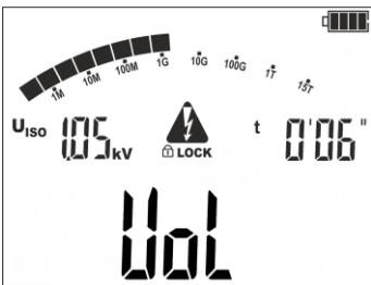
En la segunda fase del estudio se mide la resistividad volumétrica  $R_{vol}$ . En la pantalla cada 5 segundos aparece el mensaje **vol**.
