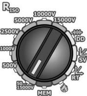
Ajustar el interruptor de función en la posición de medición  $R_{iso}$ .
