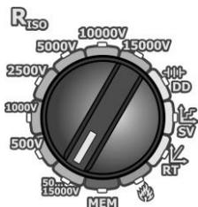
Poner el selector giratorio de función en una de las posiciones  $R_{ISO}$ , seleccionado al mismo tiempo la tensión del medición.
